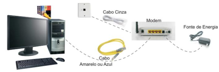
Ponto telefônico com aparelho telefônico e computador conectados simultaneamente no mesmo ponto
