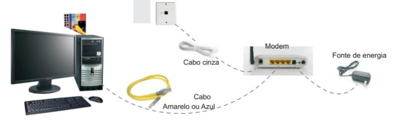
Ponto telefônico com aparelho telefônico e computador conectados simultaneamente na mesma tomada
